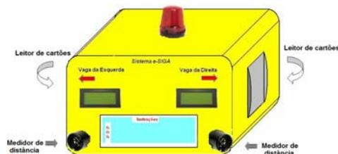
Figura 5: Parquímetro – Equipamento de Interface Com o Usuário.
